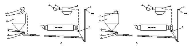
1-B250 粉煤灰输送斜槽, 2-转子秤, 3-单管螺旋锁风喂料机, 4-螺旋闸阀, 5-粉煤灰库, 6-粉煤灰库顶袋式除尘器, 7-翻板阀, 8-风机, 9-电动阀, 10-磨尾袋式除尘器, 11-磨尾提升机, 12-分格轮下料器
