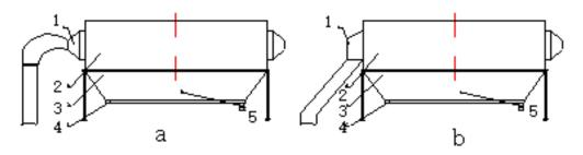
1-除尘器进风口, 2-除尘器, 3-灰斗, 4-螺旋输送机, 5-下料锁风阀 图 4 水泥磨除尘管道工艺布置简图
