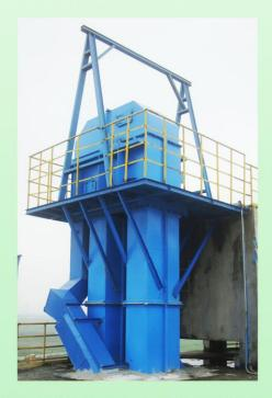
辊压机重载循环钢丝胶带斗式提升机
