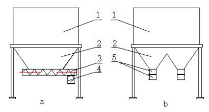
1-上箱体, 2-灰斗, 3-螺旋输送机, 4-分格轮下料器, 5-重锤翻板阀 图 1 LTMC96-6 型袋式除尘器结构简图
