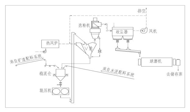
图 1 粉磨系统工艺流程图
