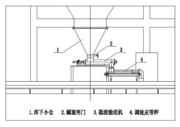
图1 下料装置示意图
