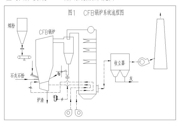
图 1 CFB 锅炉系统流程图
