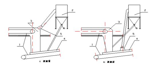
1-链斗机,2-除尘器,3-下料溜子,4-除尘罩,5-抽风管,6-翻板阀 图 2 链斗机除尘工艺布置简图
